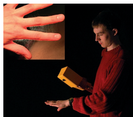
Abbildung 36. Handgerät zum Elektrosponnen von Wundabdeckungen. Die PEO-Fasern, die zwischen den Fingern haften, wurden aus Wasser elektrogesponnen.
